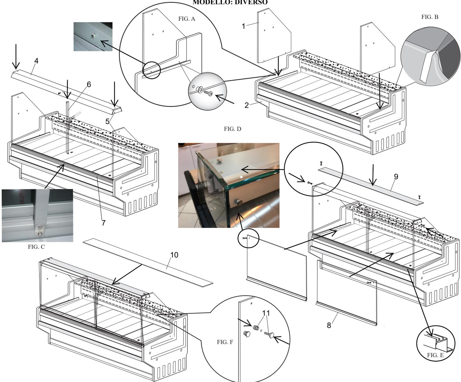
a) Dopo aver pulito il mobile in tutte le sue parti avendo seguito le istruzioni indicate nel manuale di installazione, iniziare il montaggio dei vetri. **ATTENZIONE:** durante tutta la pulizia del mobile utilizzare dei guanti da lavoro di categoria II a protezione delle mani.
