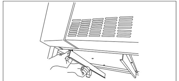
7. À ce stade, sortir le bac de la cellule et le monter en le faisant glisser sur les guides de support.
