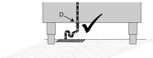
Pour les modèles 6GN 1/1 — 10GN 1/1 — 10GN 2/1, le diamètre de l'orifice de vidange est de 1/2" ; il est donc conseillé d'utiliser un tuyau d'évacuation de 1/2" ou un flexible de 25 mm de diamètre.
