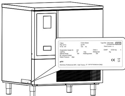
Sur les modèles **20GN 1/1**, la plaque signalétique se situe dans la partie inférieure droite de l'appareil. La plaque indiquant le code PNC et le numéro de série de l'appareil se situe sur le haut de l'appareil.
