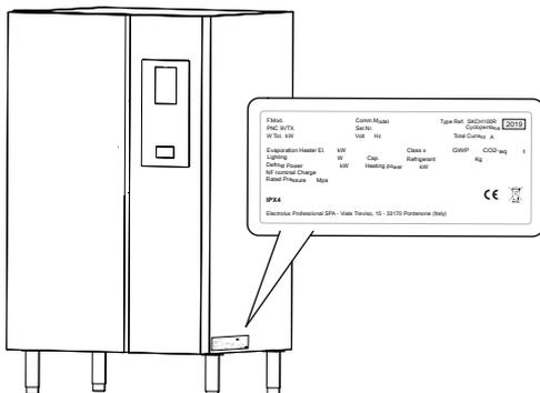
Sur les modèles **20GN 2/1**, la plaque signalétique se situe dans la partie supérieure gauche de l'appareil. La plaque indiquant le code PNC et le numéro de série de l'appareil se situe sur le haut de l'appareil.
