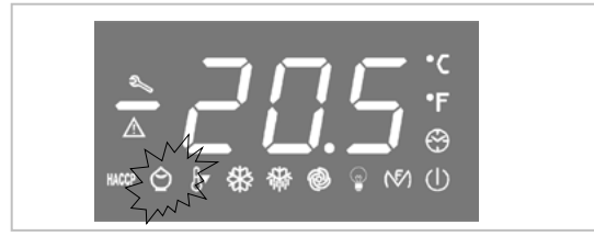
Dieses LED zeigt die Aktivierung der Funktion ENERGY SAVING an
