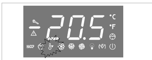
Ce LED indique l'activation de la fonction OVER COOLING (sur-refroidissement)
