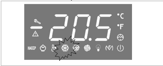
Este LED indica el estado (encendido o apagado) del COMPRESOR
