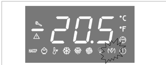
Diese LED zeigt den Zustand (ein oder aus) der TÜRHEIZELEMENTE an
